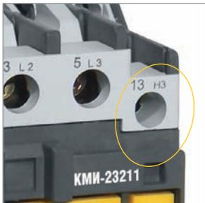
Наличие встроенных дополнительных контактов. Каждый контактор до 32 А комплектуется одним встроенным дополнительным контактом: 1НО или 1НЗ (закрывающий или размыкающий). Контактors от 40 до 95 А – комплектуются двумя дополнительными контактами: 1НО + 1НЗ.
